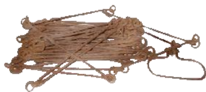
La chaîne d'arpenteur
